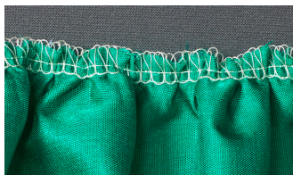
Um absichtlich zu Kräuseln, Differenzialtransport erhöhen auf einen Wert zwischen 1,5 und 2. Grössere Stichlängen erhöhen den Kräuseleffekt.
