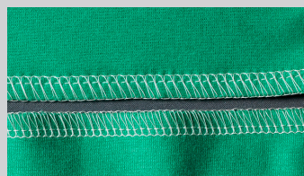
Um Nahtwellen zu vermeiden, Differenzialtransport erhöhen auf einen Wert zwischen 1 und 2.
