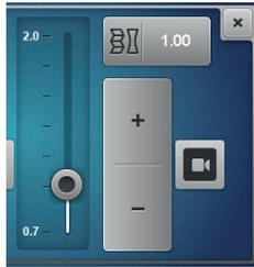
Durante il cucito le due parti delle griffe del trasporto possono essere coordinate, in modo da ottenere un avanzamento uniforme del lavoro, evitando la deformazione del tessuto e arricciature indesiderate.
